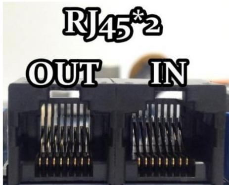
注意：当使用多台串接时，在最后一台 CN5 的 3 脚和 8 脚短路、6 脚和 7 脚短路时，即为接入终端电阻。
