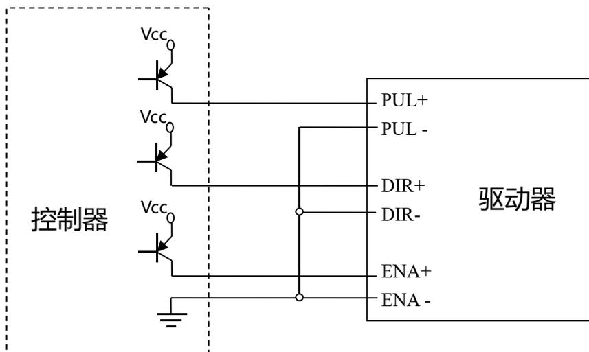
注意：脉冲、方向和脱机端子都有恒流输入功能，可以直接连接输入信号，而不用外加串联电阻降压限流保护，VCC 值为 3.5-26V。
